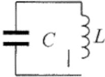
$\begin{cases} q(t) = q_{\max} \sin(\omega t + \varphi_0) \\ I(t) = q'_t = \omega q_{\max} \cos(\omega t + \varphi_0) = I_{\max} \cos(\omega t + \varphi_0) \end{cases}$ <p>Формула Томсона: <math>T = 2\pi\sqrt{LC}</math>, откуда <math>\omega = \frac{2\pi}{T} = \frac{1}{\sqrt{LC}}</math>.</p> <p>Связь амплитуды заряда конденсатора с амплитудой силы тока при свободных электромагнитных колебаниях в идеальном колебательном контуре:</p> $q_{\max} = \frac{I_{\max}}{\omega}$ |
